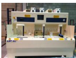
Referencia: BPS-081 SEMI-AUTOMATIC WET PROCESS STATION Año: . Marca: AKRION
