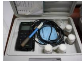
Referencia: TIP-192 PH-METRO PORTATIL Año: . Marca: WTW
